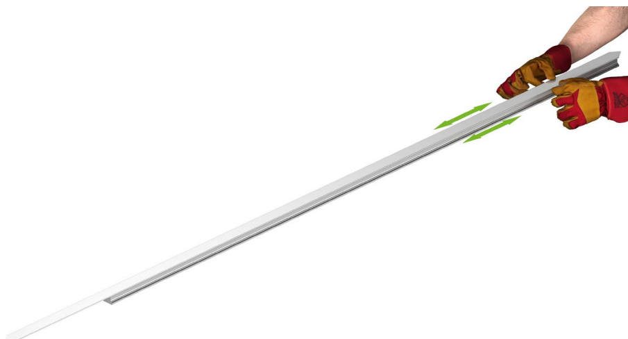
Obr. 5.28: Naklapnutí asi 3 cm zakrývacího pásku
