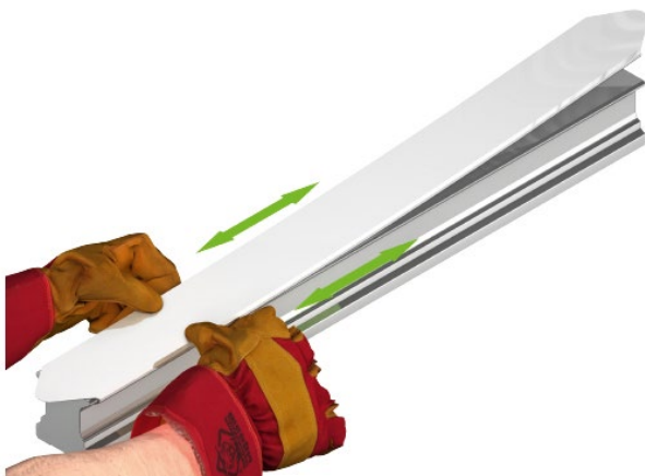
Obr. 5.27: Montáž zakrývacího pásu
